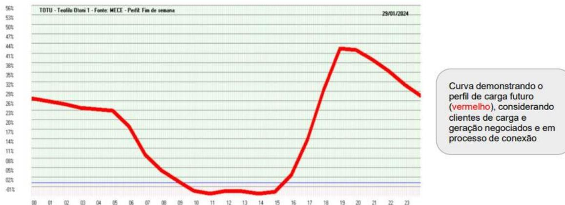
Figura 1 – Curvas típicas de potência ativa (kW) da SE Teófilo Otoni 1
